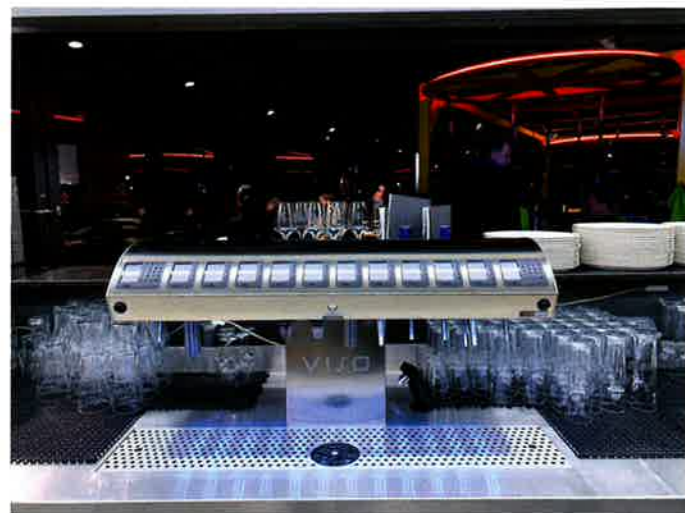
Der pneumatische Bierhahn sorgt für einen gleichmäßigen Fluss – bei Bedarf kann die Fließgeschwindigkeit an die Vorlieben des Personals angepasst werden
